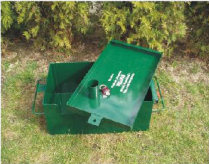
Ocelové skříně jsou vyrobeny z plechu tl. 2 mm. Rozměr výrobku je 400 x 700 x 300 mm (š/d/v). Standartní povrchová úprava je syntetická základní barva a tmavězelený lak. Na objednávku lze provést práškové lakování (komaxit) či odstín laku dle přání zákazníka. Hmotnost skříně je cca 30 kg.
